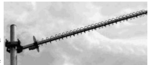
Abbildung 4: Helixantenne
